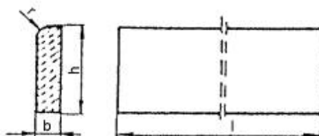
Rysunek 1. Kształt betonowego obrzeża chodnikowego
